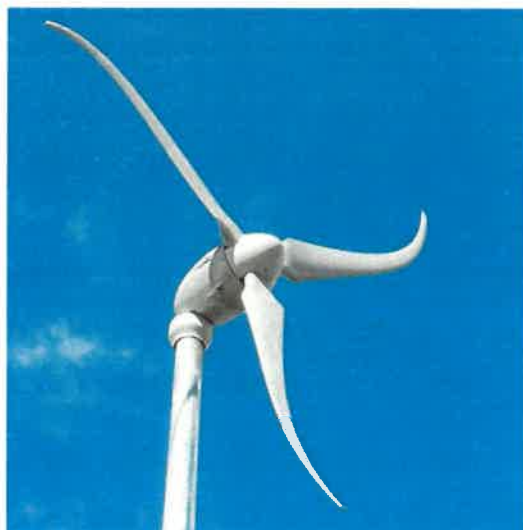
Figura Nr. 27 - Turbină cu ax orizontal
